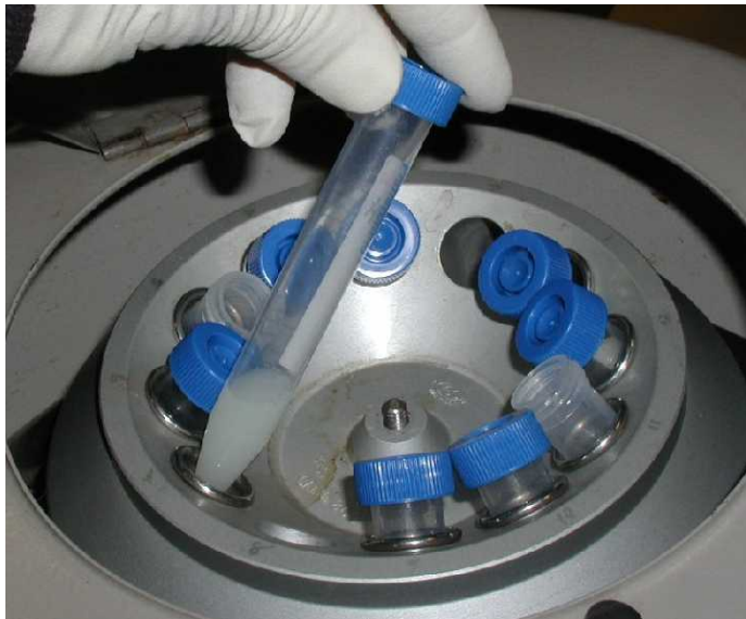
Tubos sendo colocados na centrífuga.
